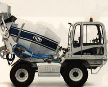
Samonakladalni mešalec za beton podjetja Fiori Group.
